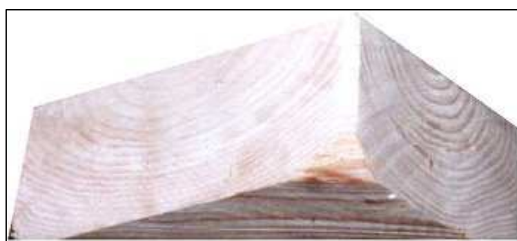
Als Keil für zylindrischer Ladung: falsch
